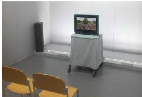
**Abbildung 1.1.:** Videolabor nach ITU-R Rec. BT.500
